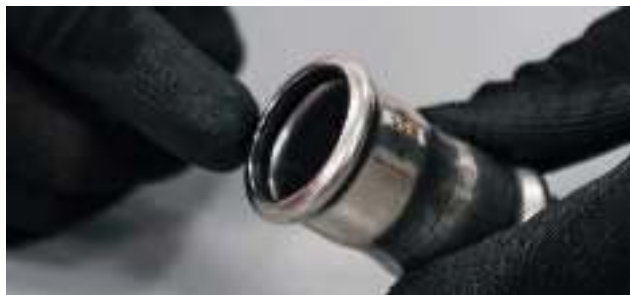
Рис. 30. Проверка уплотнительного кольца.
